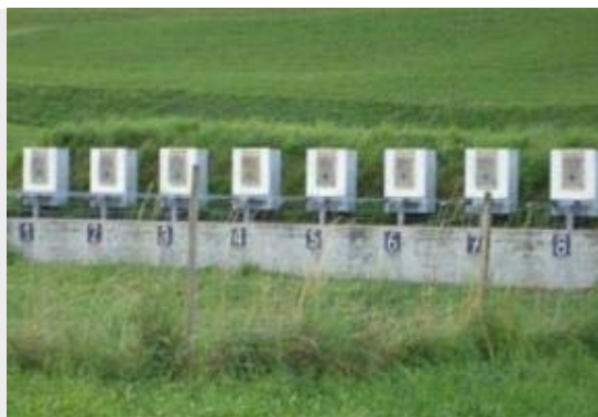
Geschossen wird auf eine elektronische Laufscheibenanlage.
